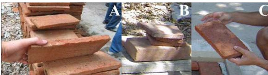
Figura 3.7. Materiales hechos a mano, foto A y C, Petatillo, y un ladrillo de 2,5 x 13 x 26 cm.; en la foto B, el ladrillo 5 cm, de espesor de las mismas dimensiones de ancho y largo.
