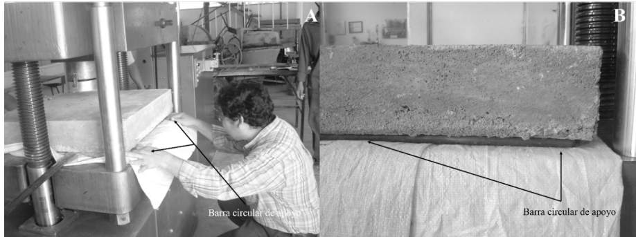
Figura 3.26. En las fotos A y B se muestra la posición del elemento en la mesa sobre dos barras circulares para las rótulas.
