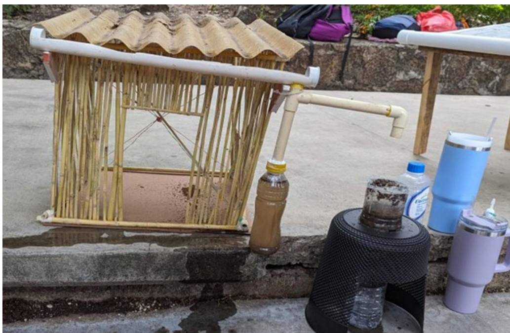
Figura 1. Colector de agua de lluvia y filtro.
